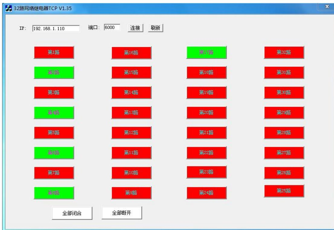
上图为继电器控制板与软件连接后图示。软件可以控制继电器动作，并显示继电器状态，软件图标红色代表断开，绿色代表闭合。
